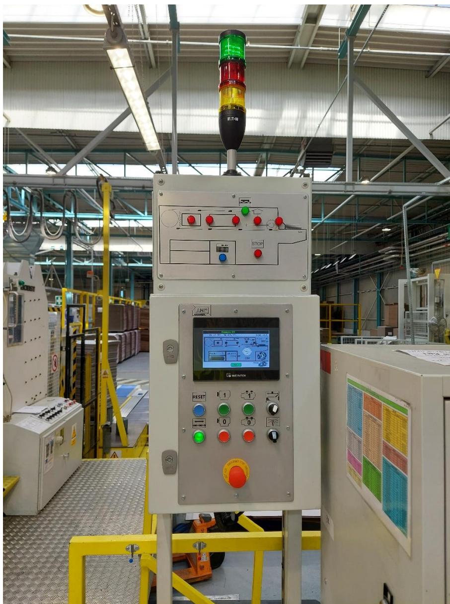
Zdjęcie 2 Panel operatora wraz z wyświetlaczem synoptycznym zdarzeń (specjalne zamówienie operatorów maszyny)
